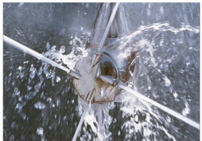
Abbildung 13: Die Auswahl der Reinigungsmodule richtet sich nach der Größe der Tanks oder Behälter sowie den herzustellenden Produkten.
