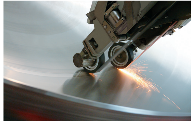
Abbildung 2: Oberflächen können auf den geforderten R a -Wert geschliffen werden.
